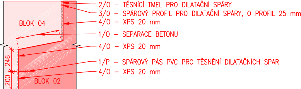
DETAIL "C", MĚŘÍTKO 1:25 DILATAČNÍ SPÁRA VE DNĚ K BLOKU PŘELIVNÉ HRANY
